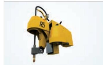
El rotator infinito R5 proporciona unas preparaciones para soldadura de alta calidad a  $\pm 50^\circ$  en chapas, tubos, perfiles y domos. El nuevo diseño ultra compacto ofrece una máxima precisión y dinámica, de modo se puedan cortar con gran fiabilidad los contornos biselados más complejos.
