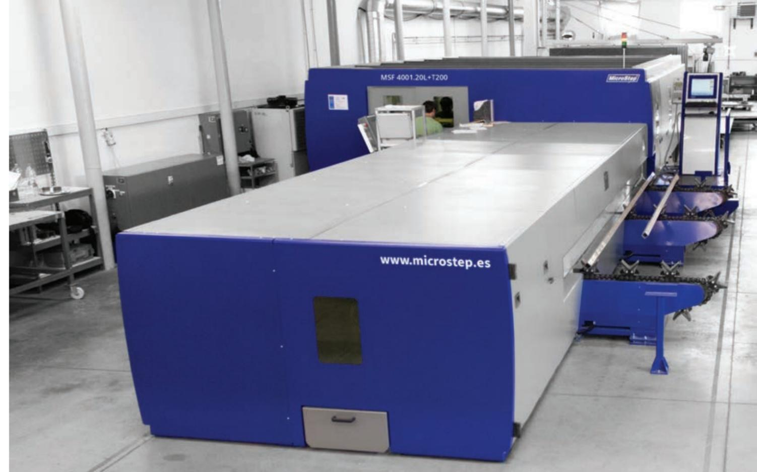
Sistema de láser compacto y dinámico con resonadores de hasta 6 kW
