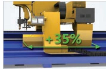
Gracias al diseño robusto de la MG se consiguen mejoras importantes para obtener unos resultados de corte excelentes, la construcción del pórtico se alarga longitudinalmente (Eje X) un 35%, lo que crea una superficie de contacto más grande para un funcionamiento más suave.
