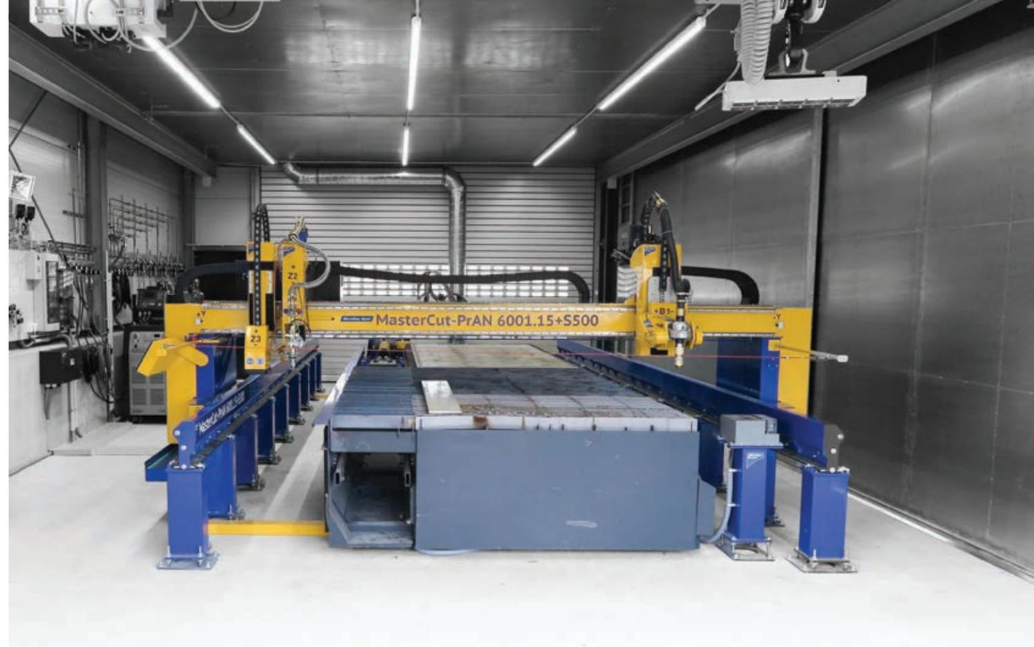
MasterCut con Rotator, sistema ACTG, corte de tubos, oxicorte y marcado por micropercusión
