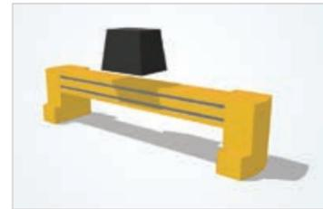
A partir de ahora, la nueva serie MG incorpora un nuevo diseño del pórtico con una construcción más rígida. Al desarrollar el nuevo diseño, la rigidez del pórtico se ha incrementado por tres, por lo tanto, ahora se producen menos vibraciones y el resultado del corte es considerablemente más preciso y fiable.
