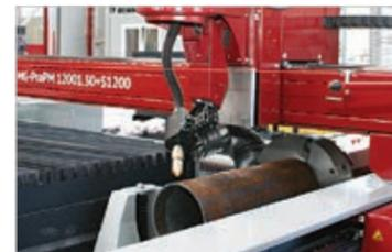
Con la MG se pueden procesar y cortar tubos y perfiles de un mínimo de 30 mm hasta 1000 mm Ø con preparación para soldadura.
