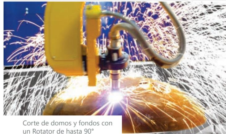
Corte de domos y fondos con un Rotator de hasta 90°
