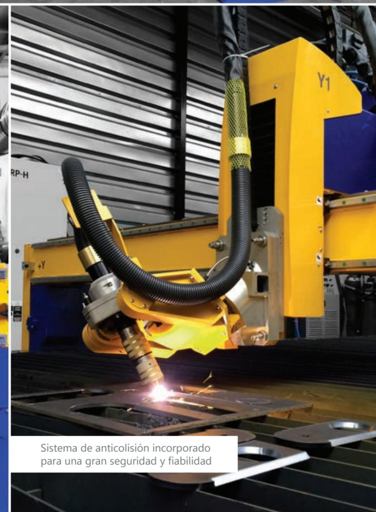
Sistema de anticollisión incorporado para una gran seguridad y fiabilidad
