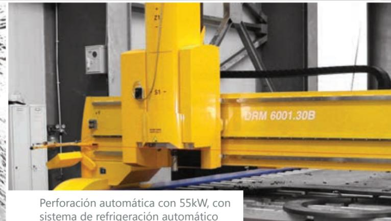
Perforación automática con 55kW, con sistema de refrigeración automático
